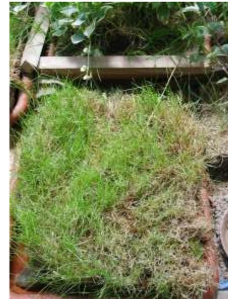
7月6日から7月12日までのオアシスⅡからの水分蒸発量は4.35 ㎖/㎡・日でした。オアシスⅡ周囲からの水分蒸発量は2.85 ㎖/㎡・日、芝生からの水分蒸発量は1.5 ㎖/㎡・日でした。
