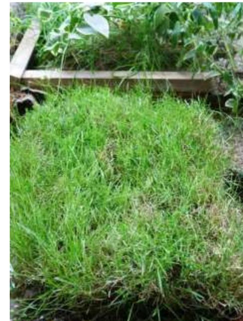
6月15日から6月21日までのオアシスⅡへの給水量は3.7ℓ/m<sup>2</sup>・日、水分蒸発量は3.5ℓ/m<sup>2</sup>・日、芝生からの水分蒸発量は1.7ℓ/m<sup>2</sup>・日でした。前回の測定と比べてオアシスⅡからの水分蒸発量とオアシスⅡ周囲からの水分蒸発量は減りましたが、芝生からの水分蒸発量は横ばいでした。
