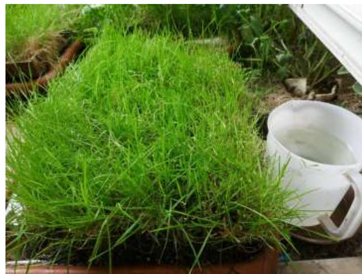
5月25日から5月31日までのオアシスⅡからの水分蒸発量は $3.1 \text{ ㍓/m}^2 \cdot \text{日}$ でした。5月の17日以来、オアシスⅡが直射日光に当たらない場所に移動しましたが、オアシスⅡからの水分蒸発量が減ると同時にオアシスⅡ周囲からの水分蒸発量も減っているのが直射日光はオアシスⅡの水分蒸発量にあまり影響がないようです。ちなみにオアシスⅡに直射日光が当たるのは一時間弱ぐらいです。そしてオアシスⅡ周囲からの水分蒸発量を測定している容器の位置は変えていません。
