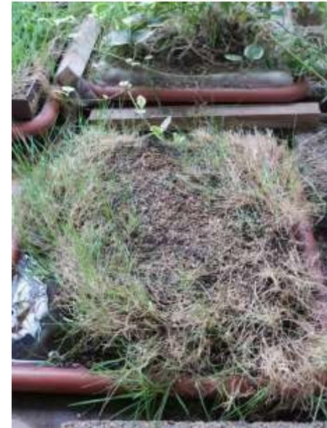
8月24日から8月30日までのオアシスⅡからの水分蒸発量は前回の測定値と同じ3.9ℓ/m<sup>2</sup>・日でした。そして芝生からの水分蒸発量は前回よりも若干増えて1.2ℓ/m<sup>2</sup>・日、オアシスⅡ周囲からの水分蒸発量は雨雲の日が増えたためか少し減って2.7ℓ/m<sup>2</sup>・日でした。
