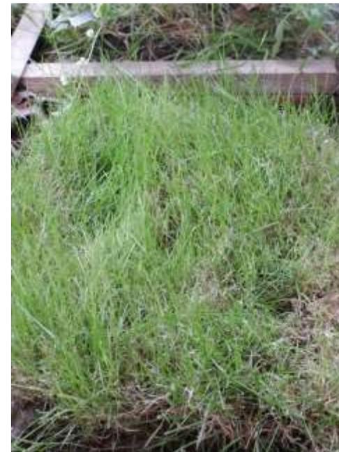
6月22日から6月28日までのオアシスⅡへの給水量は3.4ℓ/m<sup>2</sup>・日、オアシスⅡからの水分蒸発量は3.2ℓ/m<sup>2</sup>・日、そして芝生からの水分蒸発量は1.6ℓ/m<sup>2</sup>・日でした。前回と比べてオアシスⅡからの水分蒸発量や周囲からの水分蒸発量は減りましたが芝生からの水分蒸発量は横ばいでした。下記のグラフをご覧ください。
