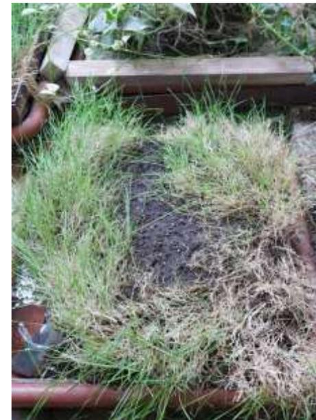
8月3日から8月9日までのオアシスⅡからの水分蒸発量は $3.8 \text{ ㍉}/\text{m}^2 \cdot \text{日}$ 、芝生からの水分蒸発量は $0.9 \text{ ㍉}/\text{m}^2 \cdot \text{日}$ 、オアシスⅡ周囲からの水分蒸発量は $2.85 \text{ ㍉}/\text{m}^2 \cdot \text{日}$ でした。
