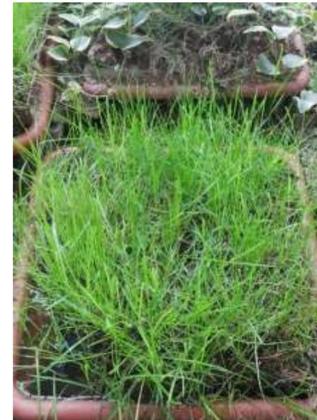
11月23日から29日までのオアシスⅡからの水分蒸発量は $3.0 \text{ ㍓/m}^2 \cdot \text{日}$ 、芝生からの水分蒸発量は $1.5 \text{ ㍓/m}^2 \cdot \text{日}$ 、オアシスⅡ周囲からの水分蒸発量も $1.5 \text{ ㍓/m}^2 \cdot \text{日}$ でした。今回の測定ではオアシスⅡ周囲からの水分蒸発量の増加が目立ちました。
