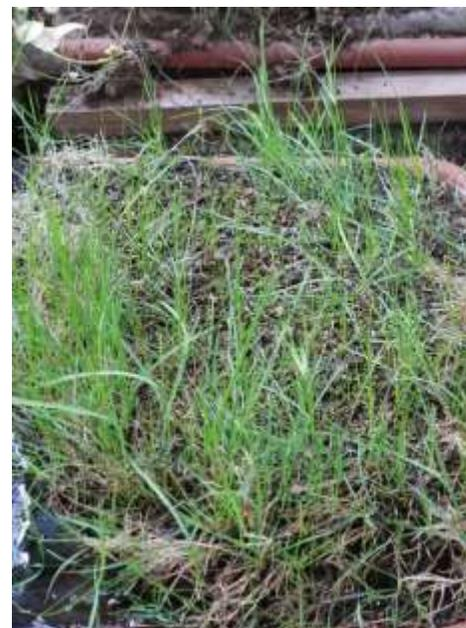
9月28日から10月4日までのオアシスⅡからの水分蒸発量は $2.8 \text{ ㍉/m}^2 \cdot \text{日}$ 、周囲からの水分蒸発量は $1.4 \text{ ㍉/m}^2 \cdot \text{日}$ でした。今回は気温が低い割には湿度が高かったので周囲からの蒸発量が少なかったようです。オアシスⅡの芝生は成長する葉が増えたせいか蒸発量が増えました。
