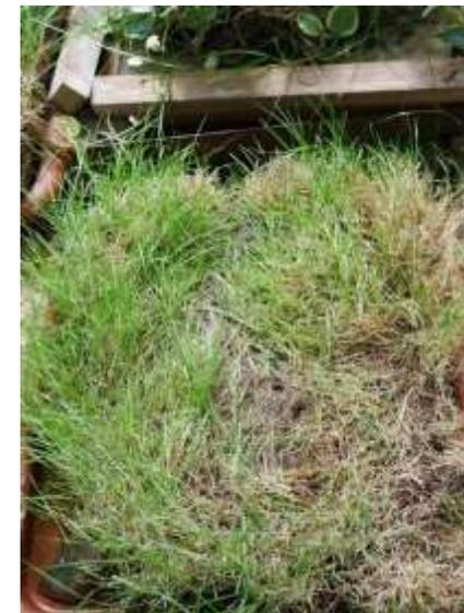
7月20日から7月26日までのオアシスⅡからの水分蒸発量は3.55ℓ/m<sup>2</sup>・日で前回の測定とほぼ同じでした。またオアシスⅡの周囲の水分蒸発量は2.85ℓ/m<sup>2</sup>・日で前回の測定よりも増えました。そして芝生からの水分蒸発量は0.7ℓ/m<sup>2</sup>・日で前回よりも減りました。
