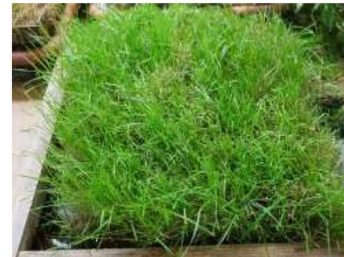
5月18日から5月24日までのオアシスⅡからの水分蒸発量は $2.6 \text{ ㍓/m}^2 \cdot \text{日}$ でした。今回はオアシスⅡを直接日が当たらない場所に移したので前回と比べて蒸発量が減ったようです。
