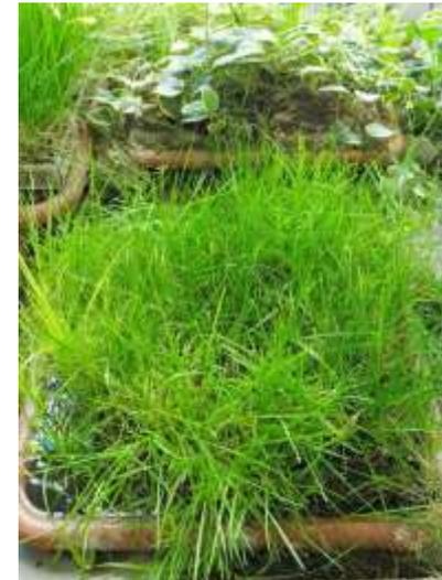
2月1日から2月7日までのオアシスⅡからの水分蒸発量は $2.5 \text{ ㍓/m}^2 \cdot \text{日}$ 、芝生からの水分蒸発量は $1.1 \text{ ㍓/m}^2 \cdot \text{日}$ 、オアシスⅡ周囲からの水分蒸発量は $1.44 \text{ ㍓/m}^2 \cdot \text{日}$ でした。今回はオアシスⅡからとオアシスⅡ周囲からの水分蒸発量が増えて、芝生からの水分蒸発量は横ばいでした。
