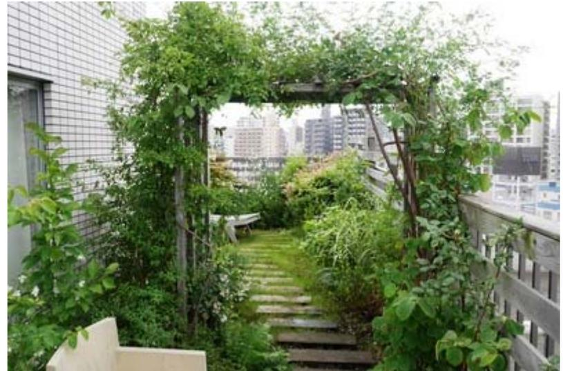
東京都内のビルの9Fに設置された風のガーデンで植物の成長が旺盛な理由は、ガーデンが建物の東に設置されていて、毎日朝日を浴びながら植物たちが活発に光合成を行える環境であること(光)、ガーデンの北と南が吹き抜けなっていて一年を通して風の通りが良いこと(風)、自動灌水システムと自然の雨の組み合わせで、常に適量の雨水を植物が吸収できる環境であること(水)、そして通気性と保水性に優れた緑化基盤ガーデンクリートが常に植物の根に、適度の水と空気を供給すること(土)の要素がそろっているからだと思います。風のガーデンで育つ直物たちを見ていて、光、風、水、土のバランスがいかに大事であるかを感じます。
